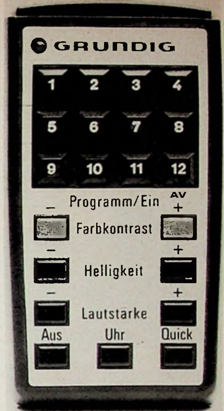
Afb. 1. Praktische uitvoering van de IR-signaalgever.
